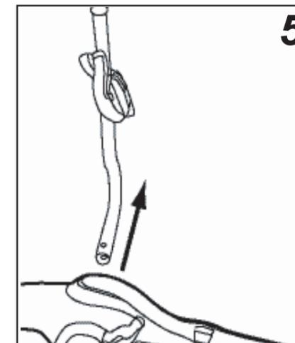
D Das Rohr ausziehen und von der anderen Seite einschieben.
