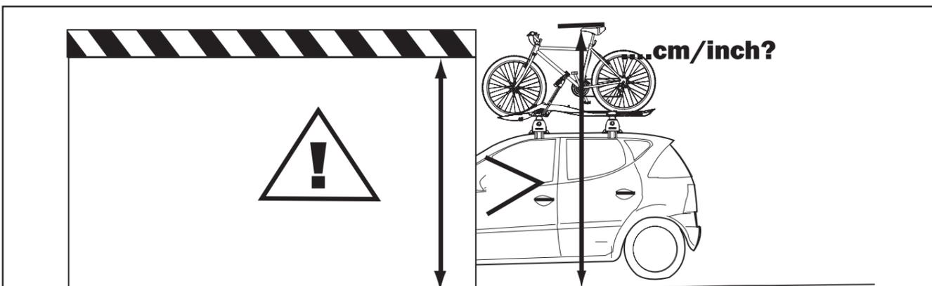
**Achtung:** Durch die Montage des Grundträgers, der Fahrradhalter und der zu transportierenden Fahrräder, verändert sich die Fahrzeughöhe. Dieses ist beim Durchfahren von Brücken, Unterführungen usw. und bei der Nutzung von **Garagen** zu beachten.
