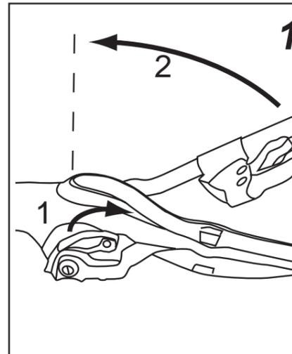
D Die Hebel öffnen und das Rohr aufrecht stellen.
