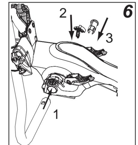
D Das Rohr, den Keil (2) und die Hülse(3) einschieben und die Hülse anziehen. Siehe Bild 7 für Moment 2-3.
